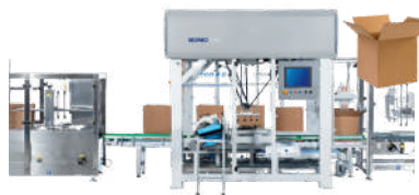
تعبئة الكراتين من الأعلى أو الجانب بالروبوتات
