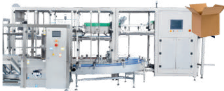
تعبئة الكراتين بالتحميل العلوي بالجابذية
